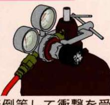
バルブが損傷を受けないよう、また容器が地震時等でも転落、転倒等して衝撃を受けないように対処しなければなりません。
