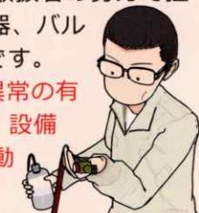
使用前、調整器の接続部、ホースの連結部からの漏えい確認は専用の検知液で行います。検査に火気を用いるのは論外です。
