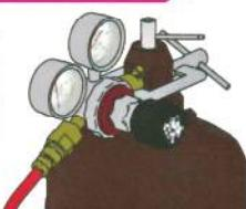
バルブが損傷を受けないよう、また容器が地震時等でも転落、転倒等して衝撃を受けないように対処しなければなりません。
