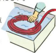
圧力調整器は製造年月から七年、吹管は五年で<sup>\*</sup>、メーカーの点検を受けるか交換を推奨します。また年に一度は自主点検を行い、安全を確保しましょう。
